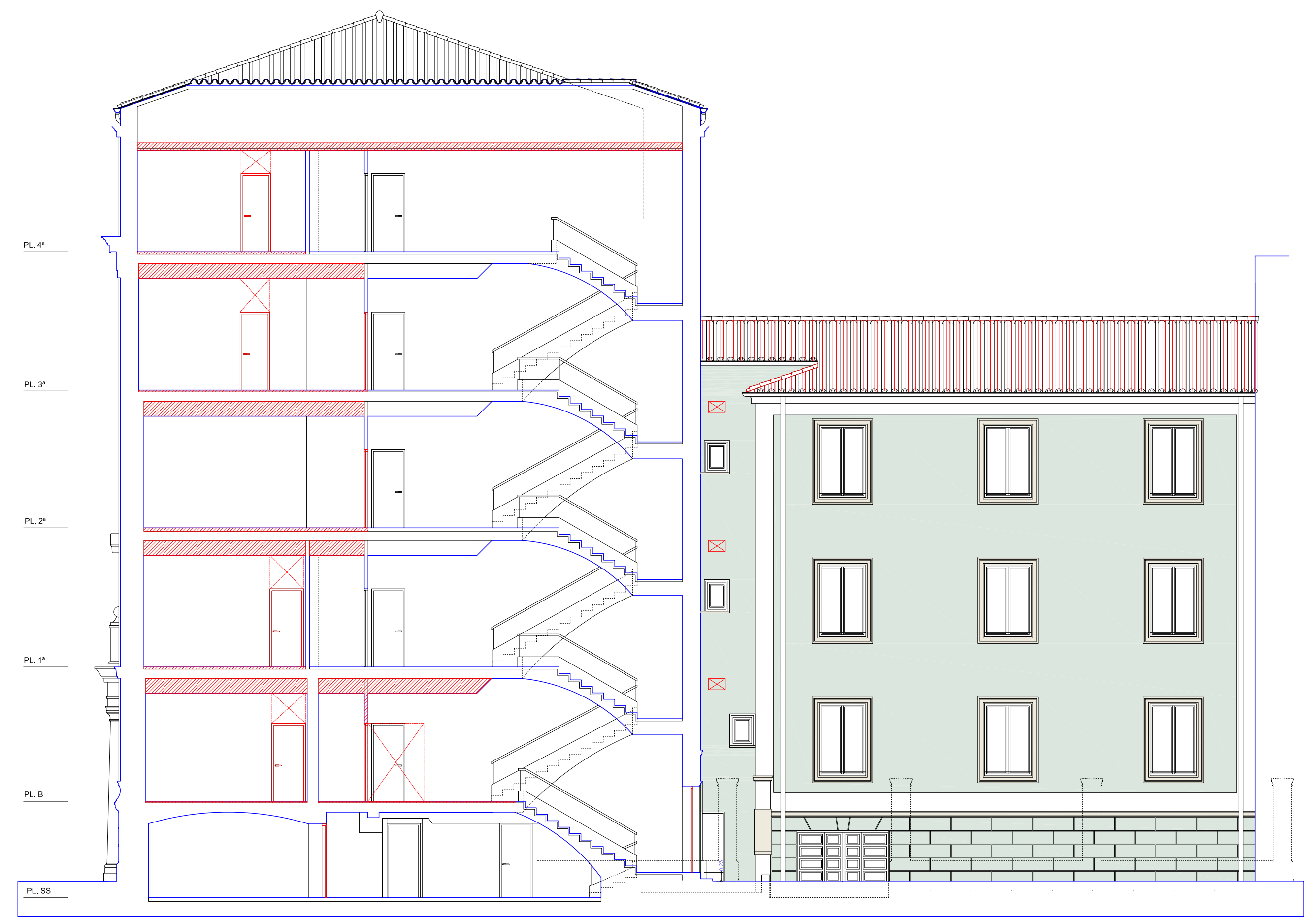
SECCIÓN LONGITUDINAL SL3
